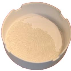
⚠ *Ha de prestarse atención, a que el fondo de la cubeta quede cubierto con una capa de perlas de sinterización y que las perlas de sinterización se puedan mover aún libremente.*
